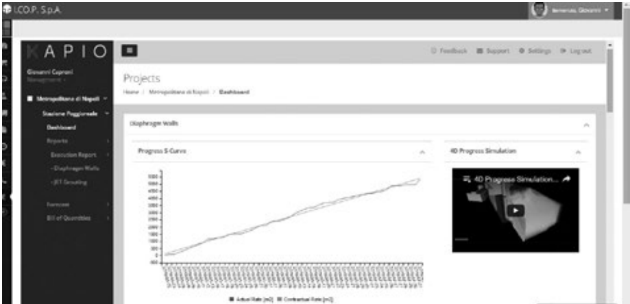
3.26 S-curve di getto dei diaframmi del pozzo della Stazione di Poggioreale.
